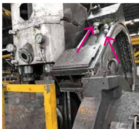
ニブリングマシンへのシマルーベとインパルスの取付事例
