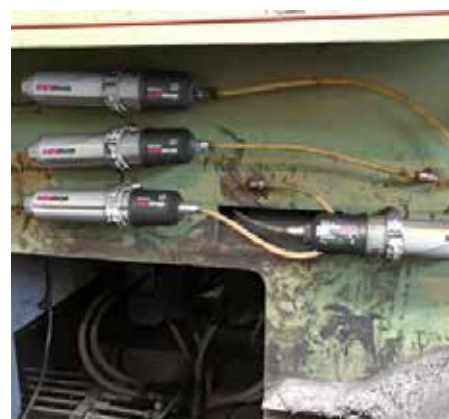
ワインダーのベアリング、ガイドブッシュへのインパルスを使用したホースでの遠隔取り付け事例
