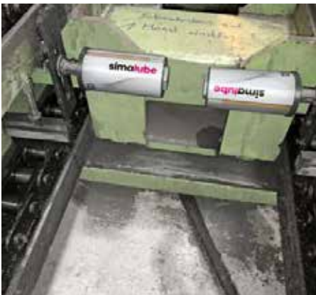
チェーンコンベヤーへの取付事例。オイル潤滑かつ専用ブラシによるチェーン清掃目的
